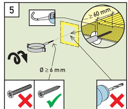
Fremdmontagen können mit Spanplatten- oder Blechschrauben ohne Schaft  $\geq 6 \text{ mm}$  direkt in den Montagequader erfolgen (Verankerungstiefe  $\geq 60 \text{ mm}$ ). Putzdurchdringung dichten (z.B. Stahlton-Klebdichtstoff).
