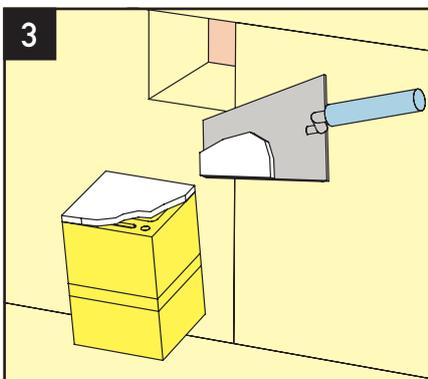
Klebemörtel (z.B. Kleber des Aussen-dämmsystems) vollflächig auf Rückseite des Montagequaders auftragen.
