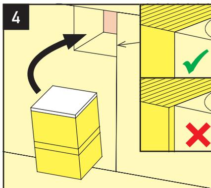
Montagequader auf tragenden Untergrund verkleben (Haftzugfestigkeit  $\geq 0.25 \text{ N/mm}^2$ ) und dämmplattenbündig anpressen. Vor Fremdmontage Abbindezeit gemäss Klebemörtel-Hersteller einhalten.
