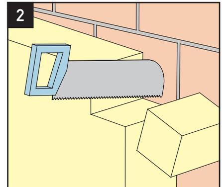
Montagequader mit Dämmung versetzen bzw. Aussparung in Dämmung ausschneiden.
